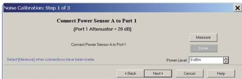
Рисунок 48 - При использовании измерителя мощности во время калибровки уровень мощности может быть оптимизирован независимо от уровня мощности канала
