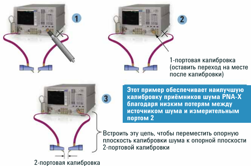
Рисунок 41 - Калибровка шума при измерениях на пластине, пример 1: подключение источника шума непосредственно к соединителю передней панели PNA-X
