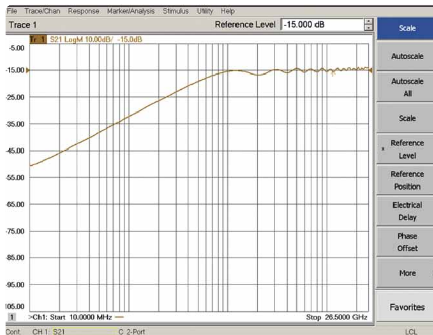
Рисунок 31 - АЧХ ответвителя измерительного порта (ответвлённый канал)
