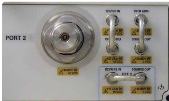
Рисунок 30 - Размещение кабельных перемычек для включения направленного ответвителя измерительного порта в обратном направлении (прямой и ответвлённый канал поменялись местами)
